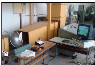
Фиг. 2 Аеродинамичната тръба в лабораторията на катедра ТХПТ
