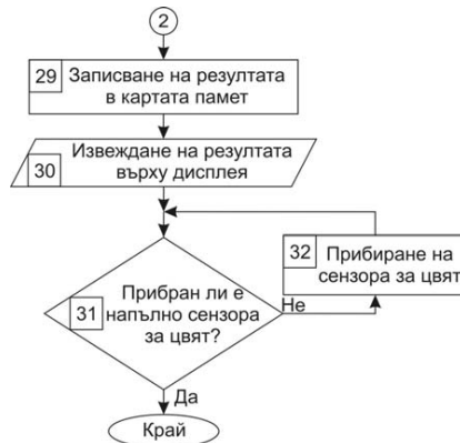
Фиг. 4б. Блоквата схема на системата за съзиране на цвetoва промяна след електромеханично въздействие
