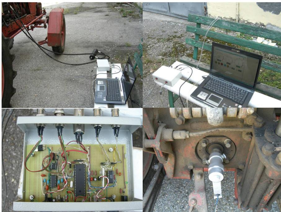
Фиг. 4. Общ вид на компютърен стенд за изпитване хидравличните системи на земеделски машини за пиково натоварване.
