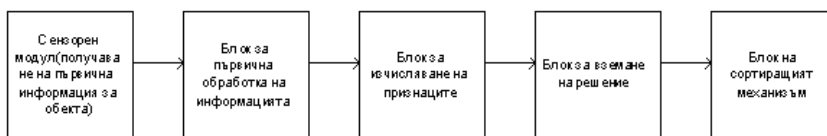
Фиг. 1. Блок схема с ключовите елементи на една разпознаваща система
