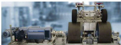
Фиг. 7. Лабораторен инерционен стенд „GIANT 9000“ на фирмата HORIBA ATS (Япония)
