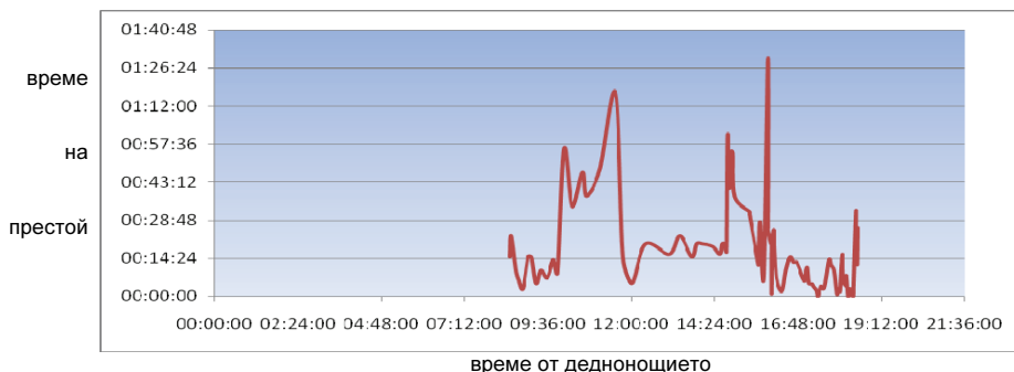
Фиг. 2. Престой на таксиметров автомобил на таксиметрова стоянка – ХАЛИТЕ Среден престой на един автомобил – 18 min 11s
