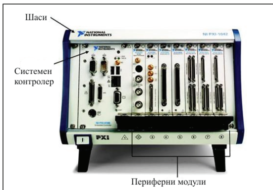
Фиг.1. Общ вид на 8-слотово PXI шаси с вграден системен контролер и периферни модули.
