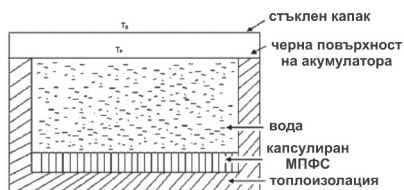
Фиг. 7. Конструкция на соларен колектор с капсулиран МПФС на Prakash et al. [6]
