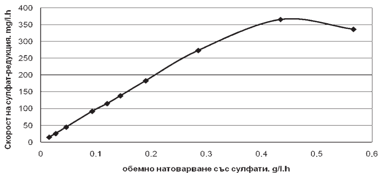
Фиг. 5. Влияние на обемното натоварване на биореактора със сулфати върху скоростта на процеса
