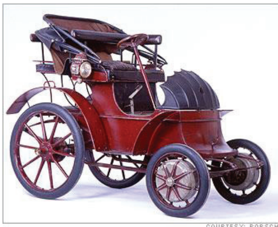
Фиг. 3. Фердинанд Порше и Лудвиг Лохнер. Електромобил с двигател, разположен в главините на колелото. 1900г.
