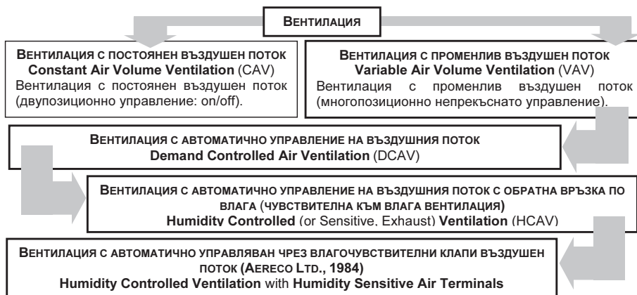
Фиг. 2. Място на чувствителната към влага вентилация с автоматично управление на въздушния поток (HCAV) в общата класификация на вентилационните системи
