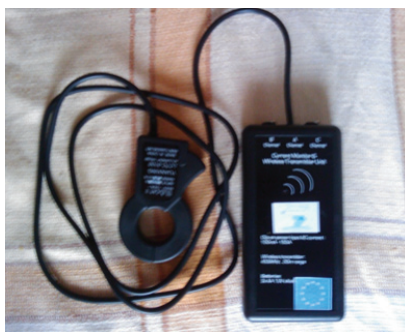
Фиг. 1 Ампер-клещи и трансмитер за измерване и предаване на отчетената консумирана електроенергия
