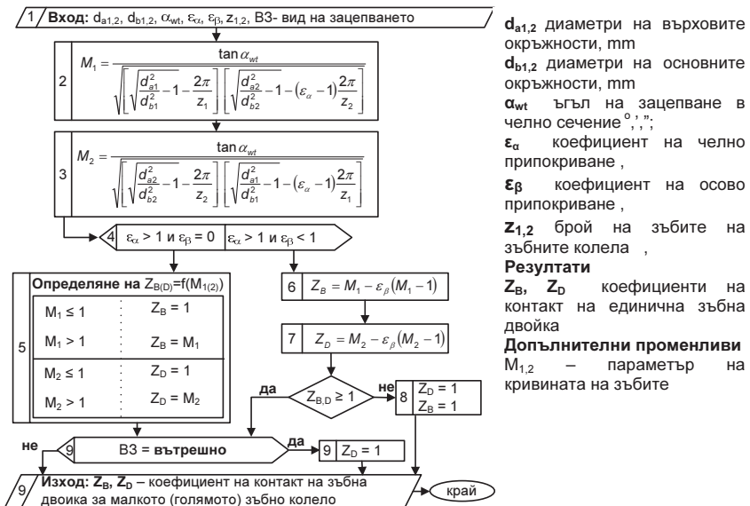
Фиг. 2 Определяне на коефициентите Z_B и Z_D
