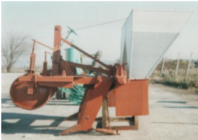
Фиг.1. Общ вид на преустроен прорезвач-ходообразувател ЩН-2-140 с бункер за мулч.
