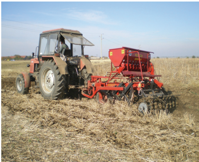
Фиг.2. Сеитбен агрегат „Беларус 952“ и сеялка СКС – 2.0
