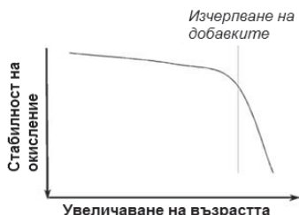
Фиг.1. Зависимост между стабилността на окисление, добавките(присадките) и възрастта на маслото [2]
