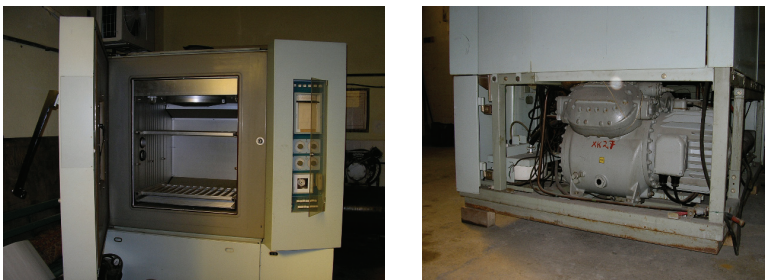
Фиг.1. Нискотемпературна камера с ДКХМ, разработена в катедра ТХЕ на Русенски университет
