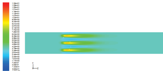
Фигура 4. Скоростно поле, 25% порьозност на мезоструктурата, z-velocity, равнина x=0.875\text{mm}
