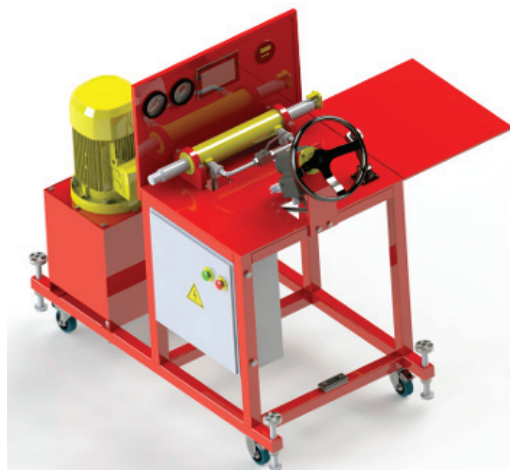
Фиг.5 3-D модел на стенд за изпитване на ЕХКУ тип OSPE – Общ изглед.
