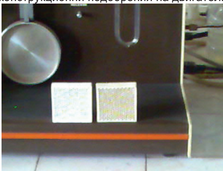
Фиг. 1. Кордиеритова плоча от типа „пчелна пита“ („Техкерамик“ Мездра) без покритие (дясно) и с каталитично покритие, разработено от ИК-БАН
