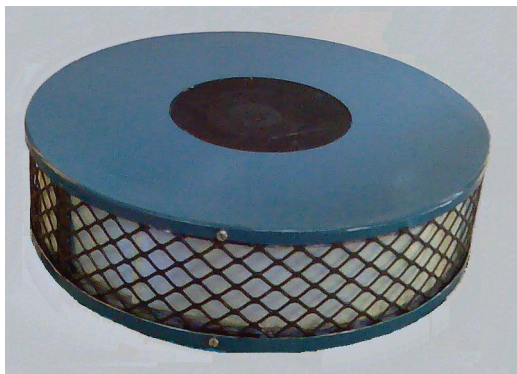
Фиг.5 Фотокаталитичен въздухопречиствател SKR-1 предназначен за очистване на въздух от цигарен дим в затворени помещения с обем до 40 \text{ m}^3 , осигуряващ 6-кратна циркулация на въздуха през фотокаталитичния слой.
