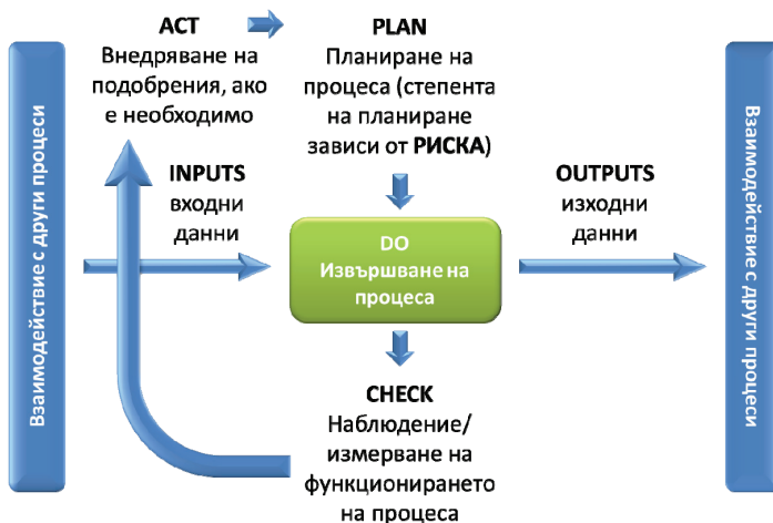
Фиг.3 Схематично представяне на процес от системата за управление на качеството (по ISO/DIS 9001:2014)
