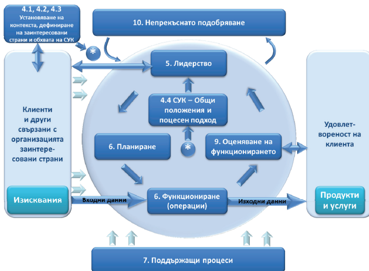
Фиг.2 Модел на система за управление на качеството, основана на процесите, който показва връзките между клаузите от новата версия на ISO 9001 (по ISO/DIS 9001:2014)
