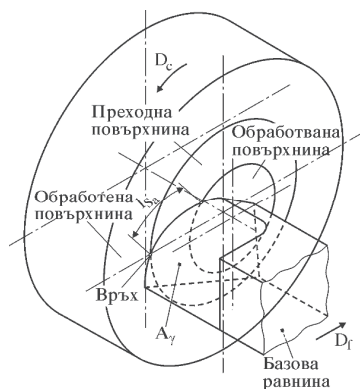
Фиг. 11 Подрязване - изпъкнал режещ рѣб, част от равнинна или пространствена крива; обратна схема
