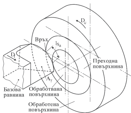
Фиг. 10 Подрязване - изпъкнал режещ рѣб, част от равнинна или пространствена крива; права схема
