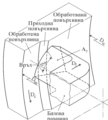
Фиг. 9 Разстъргване - изпъкнал режещ рѣб, част от равнинна или пространствена крива; обратна схема
