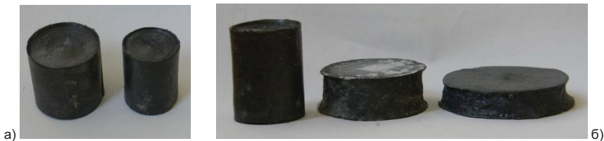
Фиг. 3 Оловни проби за изпитване на натиск без контактното триене
