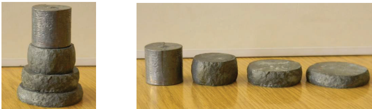
Фиг. 2 Оловни проби ( \varnothing 40 \times 38 ) при изпитване на натиск без смазване
