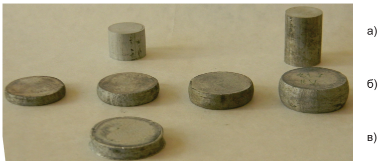
Фиг. 2 Изпитвани алуминиеви проби: а – преди изпитване; б – след изпитване без смазване; в – след изпитване без триене
