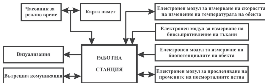
Фиг.1. Структурна схема на електронната система
