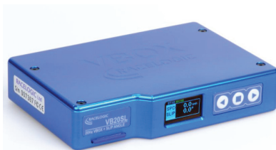
Фиг. 1. Система за измерване на параметрите на движение VBOX 20SL GPS Data
