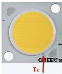
Фиг. 1. Снимка на светодиоден модул Cree XLamp CXA2011 LED; T_c – място за монтаж на термодвойка [1].
