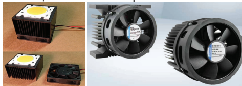
Фиг.1. Вентилатори в системите за охлаждане на електронни компоненти.
