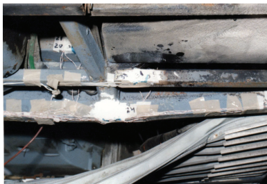
Фиг. 4. Разположение на характерни точки, в които се измерва напрежението на фермата на автобуса (т.20, 21 и 24).
