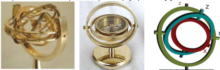
Фиг.1 Пръстеновидно окачване(кардан)
