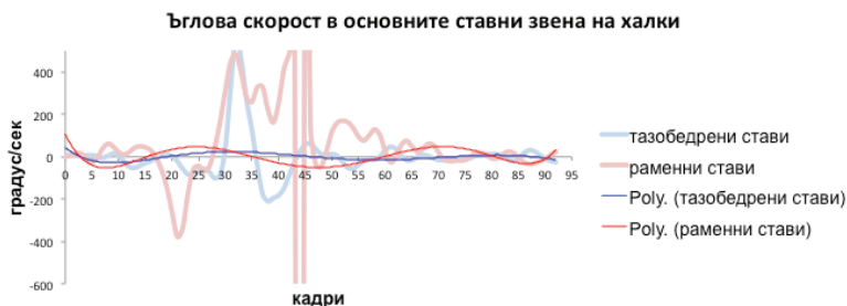
Фиг. 7. Апроксимация на ъгловата скорост в основните ставни звена при въртеж изпълнен на халки
