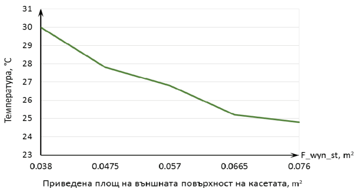
Фиг.6. Влияние на приведената външна повърхност на касетата върху температурата на касетата.
