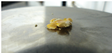
Фиг.6. Зърно изпитано до пълно разрушаване
