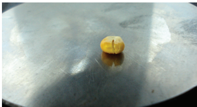
Фиг.5. Начален етап на разрушаване
