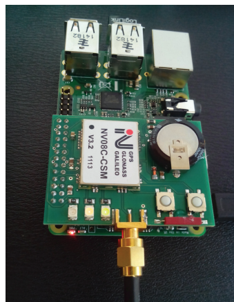
Фиг. 6. Асемблиран GNSS приемник използващ Raspberry Pi
