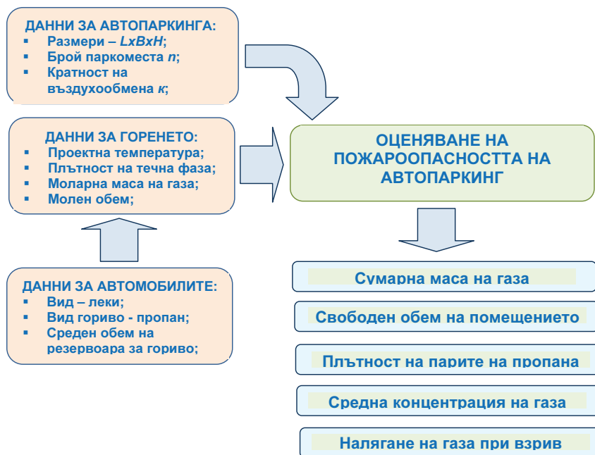
Фиг. 2. Структурна схема за действията по оценяване на пожароопасността на закрит паркинг при автомобили с АГУ
