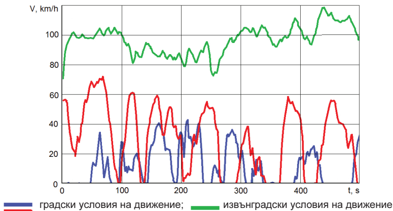
Фиг. 4. Изменение скоростта на движение в определен интервал от време при различни условия на движение
