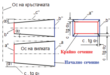
Фиг.1 Параметричен модел на рамената на вилките a \times b , a^* \times b^* – размери на началното и на крайното сечение; c – дължина на рамената; \alpha_1, \alpha_2, \alpha_3 – ъгли за дефиниране на крайното сечение
