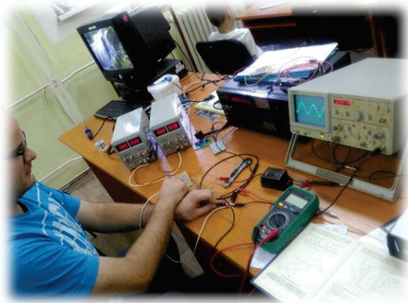
Фиг. 7. Практически получена идеална синусоида с диодна матрица
