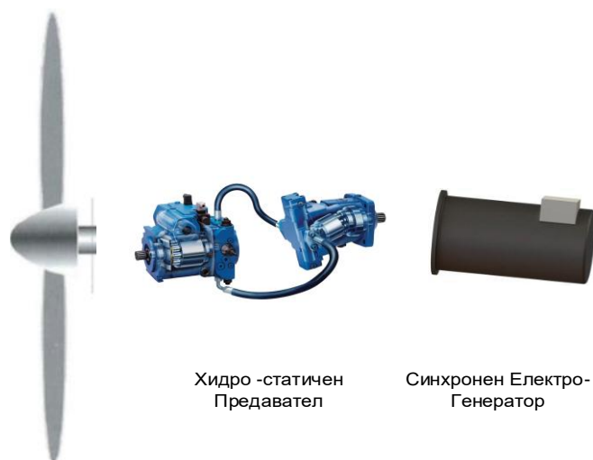
Фиг. 4. Ветрогенератор с хидростатичен предавател
