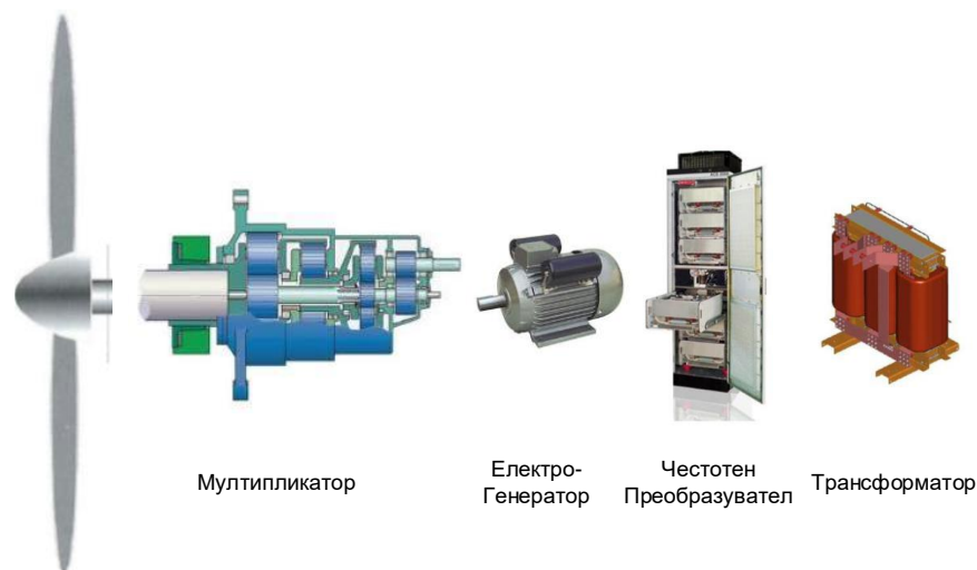
Фиг. 3. Предаване на енергията чрез мултипликатор
