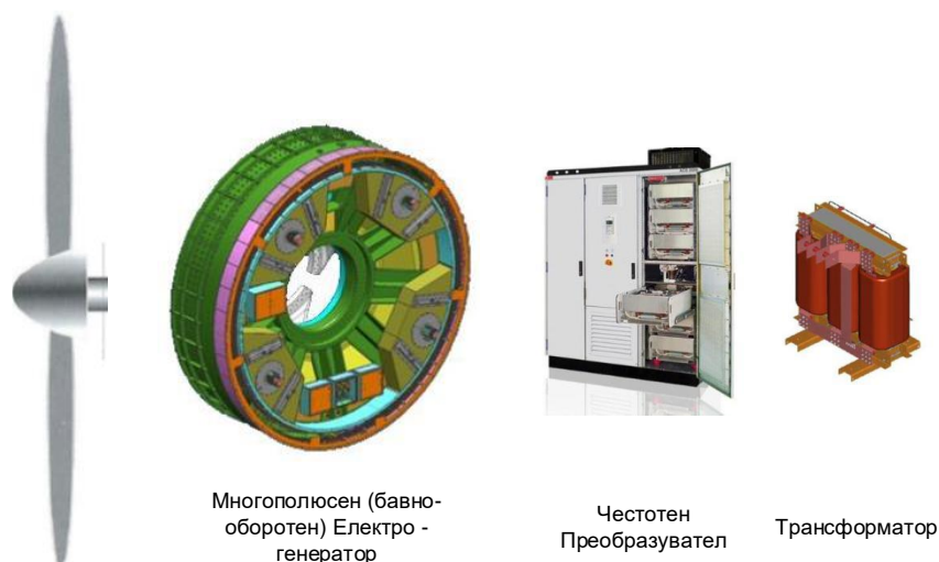
Фиг. 2. Директно предаване на енергията във ветрогенераторите
