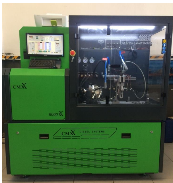
Фиг. 4. Универсален стенд за изпитване на дизелови горивни системи CMX6000X
