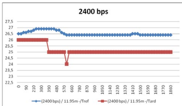
Фиг.6. Зависимост на измерване на температурата с референтен термометър и сензорът за температура към Arduino модул за скорост на предаване на информация 2400bps на разстояние 11,95м
