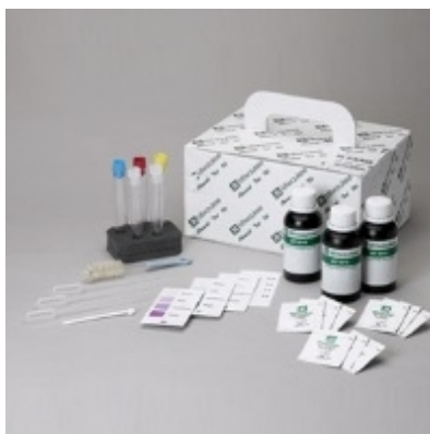
Фиг. 3. Почвен кит за измерване на концентрацията на трите основни химични елемента азот, фосфор и калий в проба от почвата
