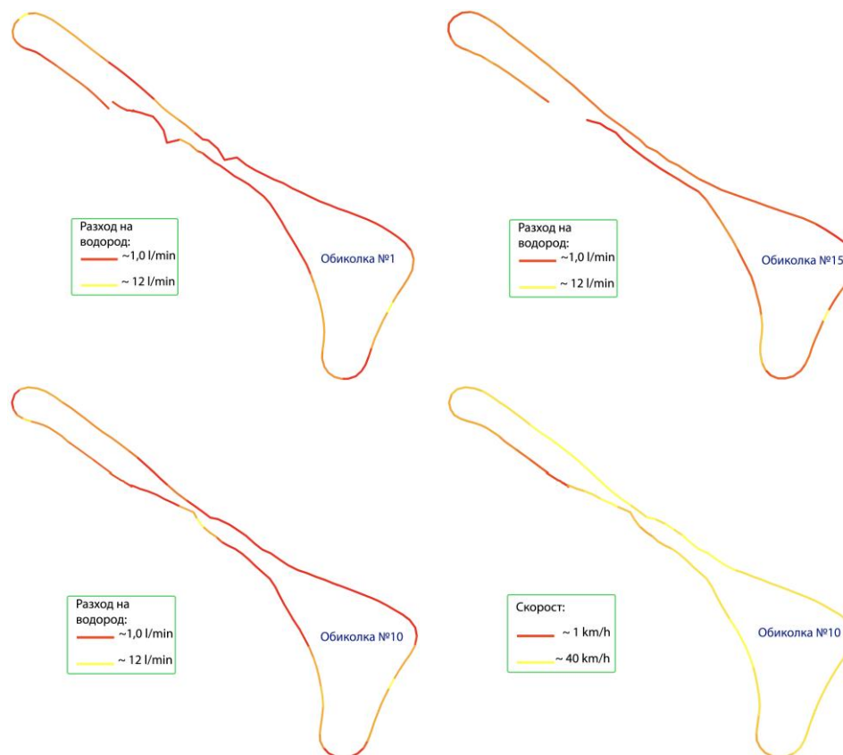
Фиг. 8 Разход на водород (l/min) и скоростни характеристики (km/h) по време на тестовете
