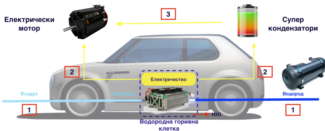
Фиг. 3 Енергийна диаграма на автомобила
