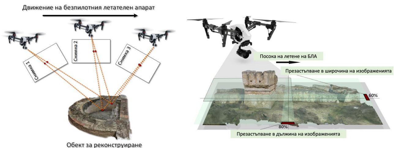
Фиг. 1 Принцип на фотограметрията с използване на БЛА
