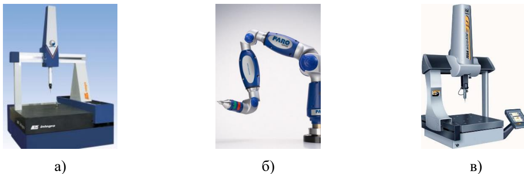
Фиг. 3 СММ: а) традиционен ( http://www.globalspec.com ), б) портативен ( http://www.globalspec.com ) и в) многосензорен скенер ( http://www.directindustry.com )
