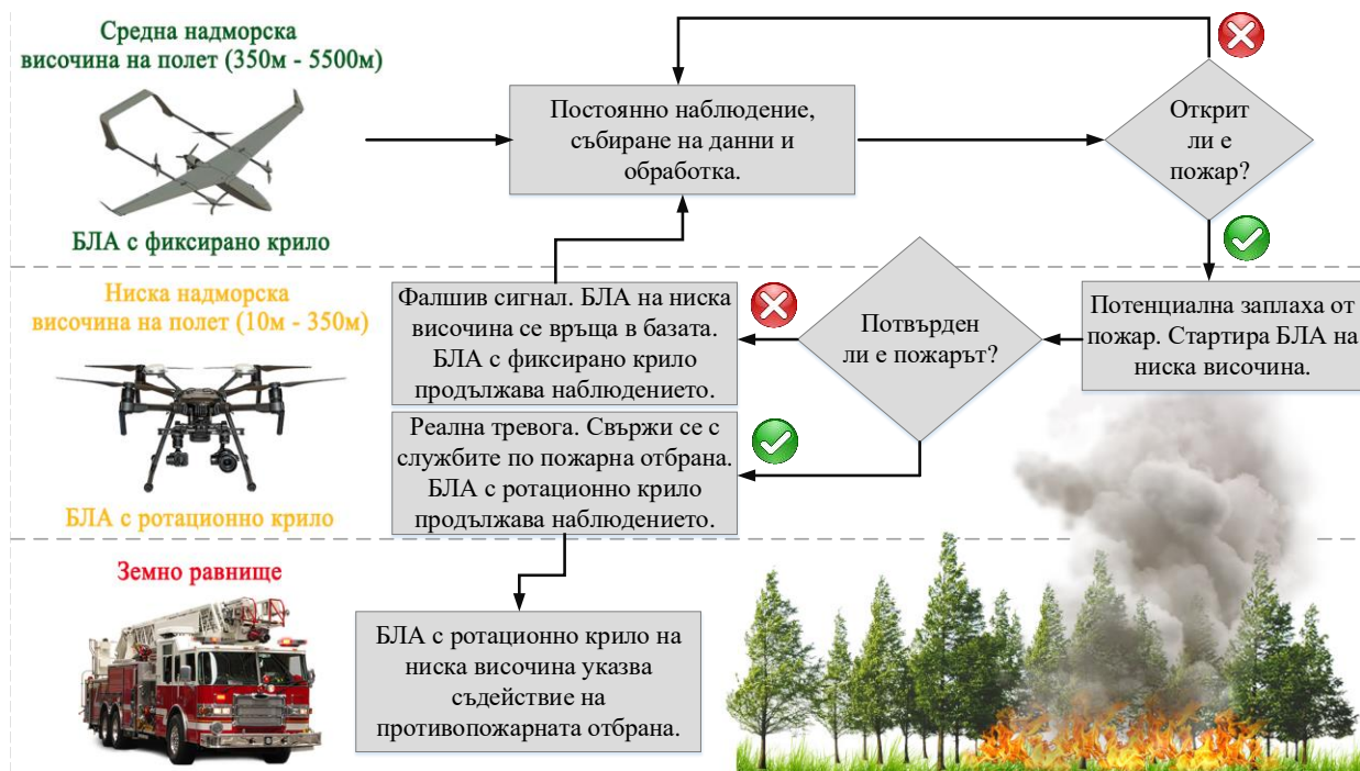
Фиг.1 Концептуален модел на система за ранно откриване на горски пожари реализирана с БЛА с фиксирано крило и БЛА с ротационно крило.
