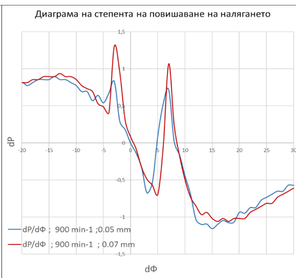
фиг.2 Диаграма на степента на повишаване на налягането при празен ход , при ход на управляващия клапан 0,05 и 0,07 mm.
