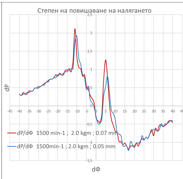
фиг.4 Диаграма на степента на повишаване на налягането в режим с натоварване 2 kgm при 1500 min -1 , при ход на управляващия клапан 0,05 и 0,07 mm.
