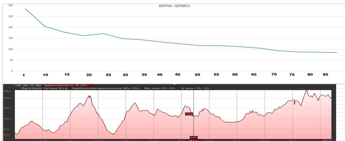
Фиг.5. Разреждане на батерията Варна-Шумен с топографски особености на трасето
