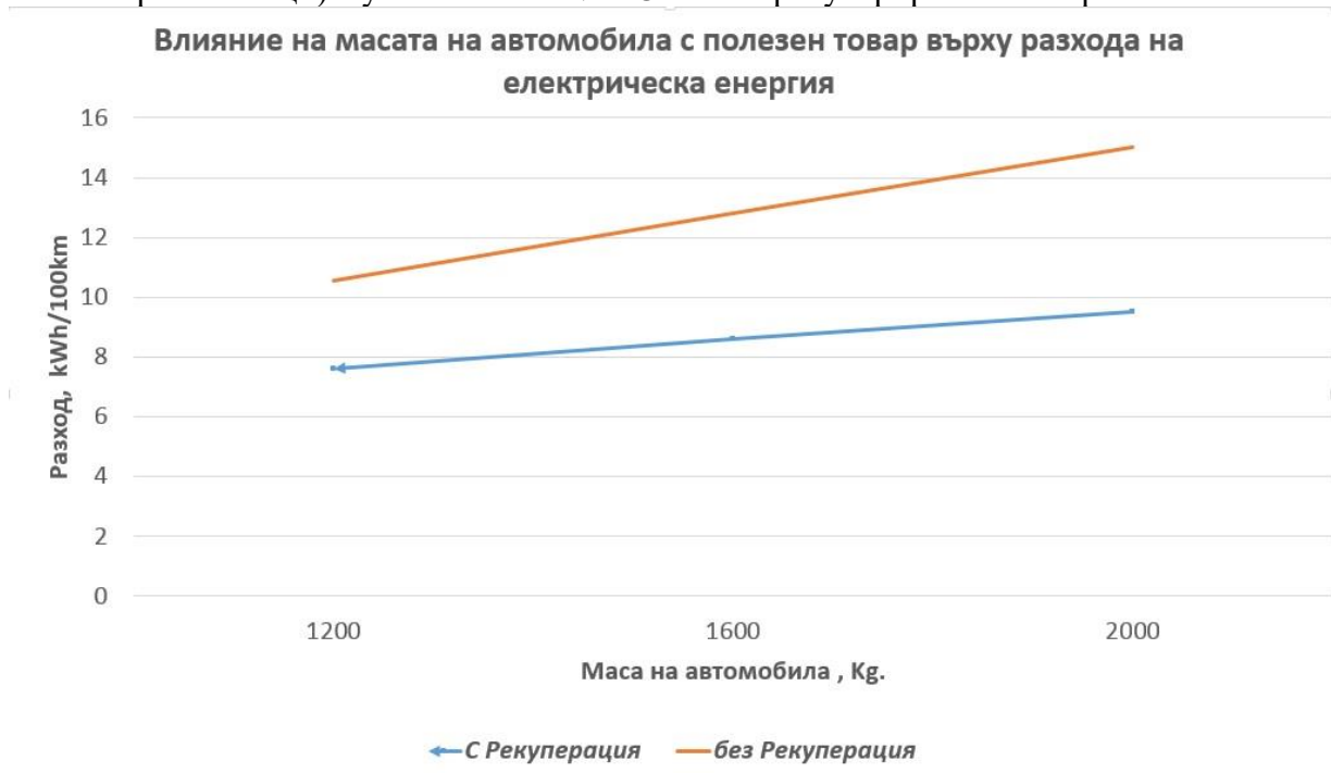
Фиг.3. Влияние на масата на автомобила (с полезен товар) върху разхода на електрическа енергия
