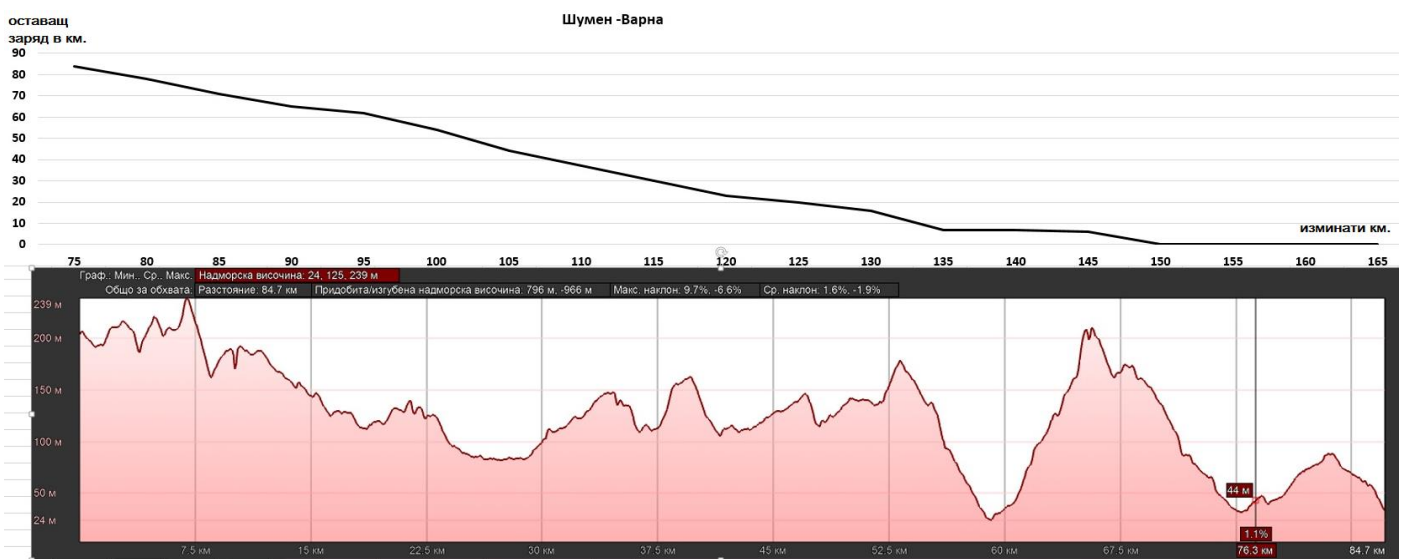
Фиг.6. Разреждане на батерията Шумен- Варна с топографски особености на трасето
