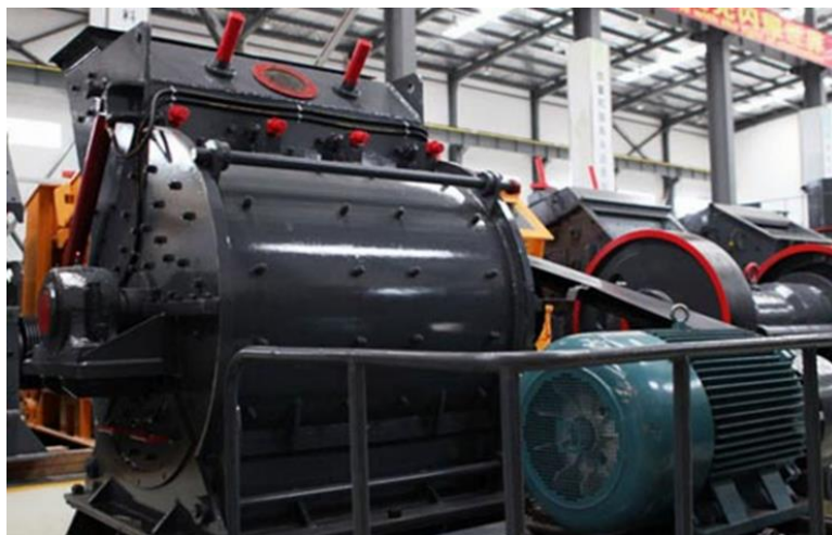
Фиг. 2. Чукова трошачка за рециклиране на строителни отпадъци
