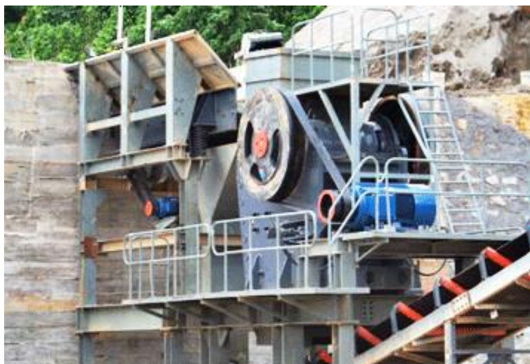
Фиг. 3. Челюстна трошачка за рециклиране на строителни отпадъци
