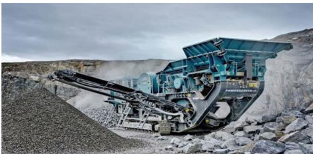
Фиг. 1. Мобилна роторна трошачка ( Powerscreen Premiertrak R400X)
