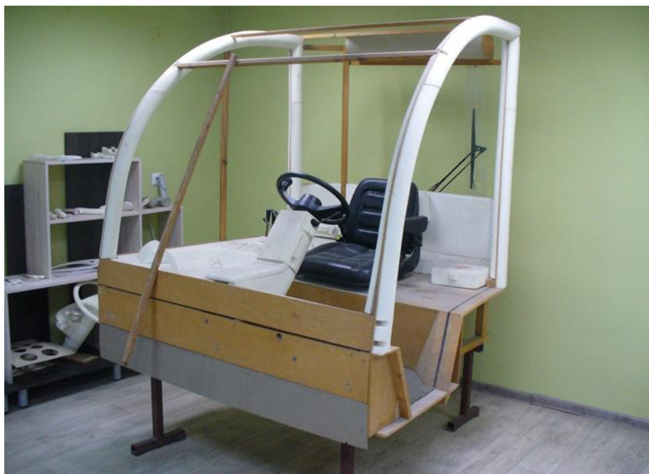
Снимка 12. Посадъчен макет на кабина за мотокар, М 1:1
