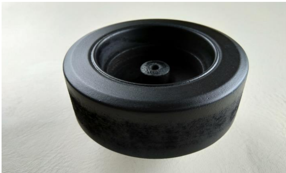
Снимка 13. Частичен макет на колело на транспортно средство, М 1:5
