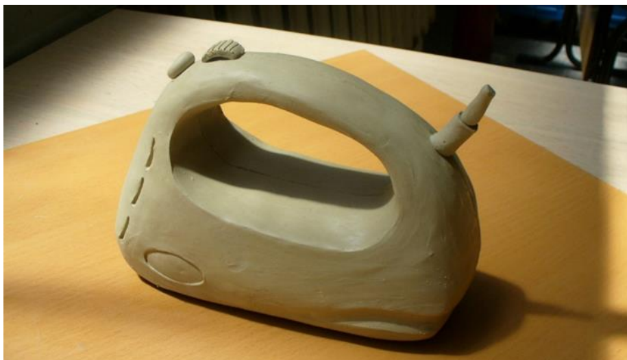
Снимка 7. Търсещо решение, мек макет от пластилин на миксер
